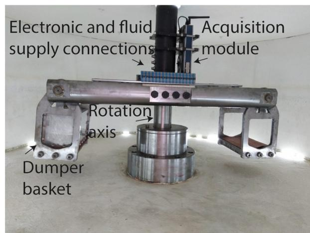
**Figure 1.** Geotechnical centrifuge at Escuela Colombiana de Ingeniería Julio Garavito.
